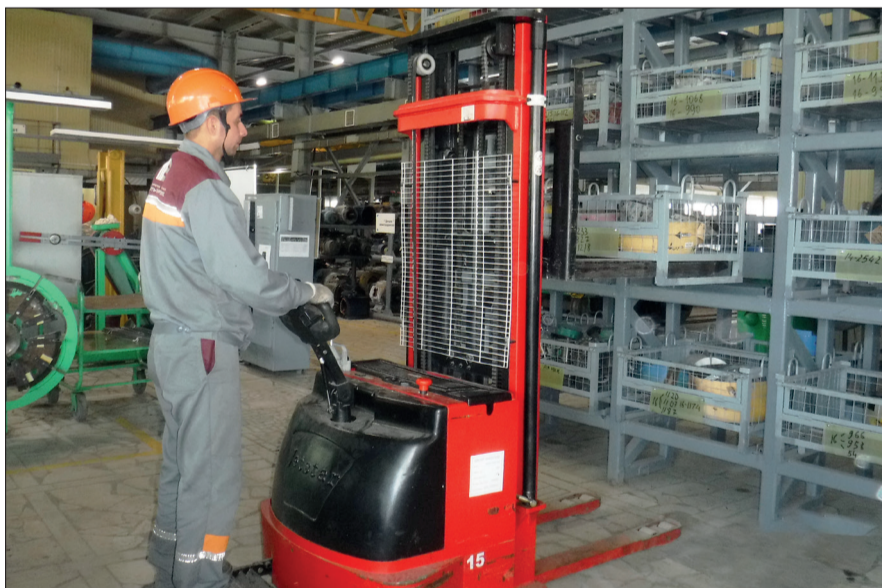
Применение самоходного штабелера для размещения тар на многоярусных стеллажах
